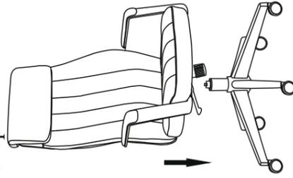
**Шаг А.** Вставьте ролики (2) в крестовину (1). Снимите с газлифта (3) колпачок (при наличии) и вставьте его в отверстие крестовины.
